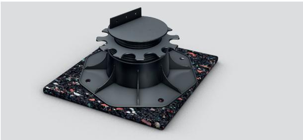
Das Isopad mit Beschichtung dient zum Schutz vor mechanischen Beschädigungen auf hochwertigen Dachabdichtungen. Es besitzt eine unterseitige Verbundfolienkaschierung, die als integrierte Trennlage (Weichmacherbarriere) bei Unverträglichkeit zu PVC-Dachabdichtungsbahnen fungieren kann. Bei einer punktuellen Unterlegung der Unterkonstruktion entsteht kein direkter Kontakt zum Untergrund und das Wasser kann barrierefrei ablaufen. Zusätzlich wird der Trittschall gedämpft.
