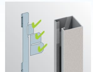
Profilträger für **U-Profil**: Die Flügel bleiben wie werkseits geliefert.
