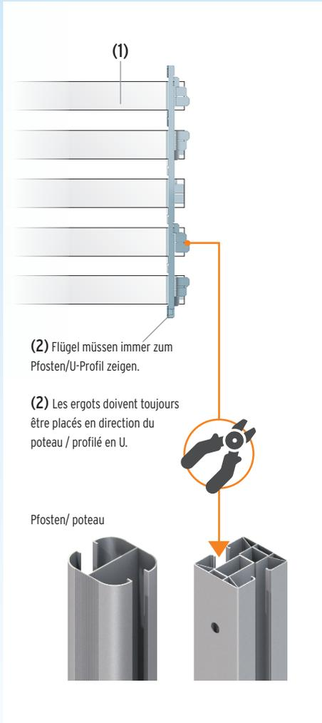
Die SYSTEM RHOMBUS Profile (1) werden mit Hilfe der Profilträger (2) vorsichtig in die SYSTEM Pfosten bzw. in das SYSTEM U-Profil eingeschoben.
